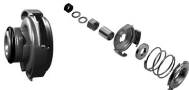
L'arbre de la pompe est raccordé à l'arbre du moteur par l'intermédiaire d'un filetage à gauche et d'un ajustement serré. L'arbre ne peut pas être démonté.
