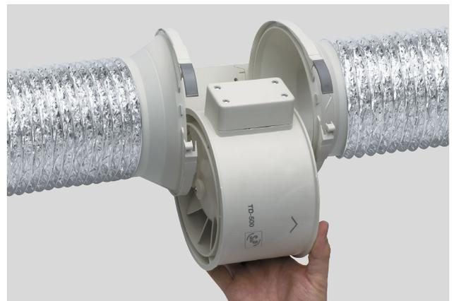
La conception unique des supports à brides de fixation permet au corps moteur-hélice d'être monté ou démonté facilement sans nécessité de démonter le conduit.
