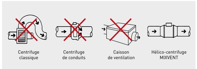
La hauteur réduite de la série TD-MIXVENT est la meilleure solution pour les installations où l'encombrement est limité comme dans les faux-plafonds.
