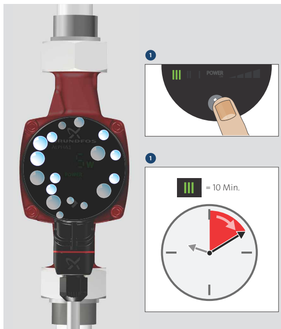
Fig. 12 Purgé du circulateur
